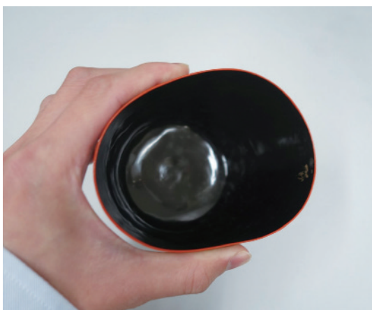
写真1 指圧で変形する馬毛胎漆器
