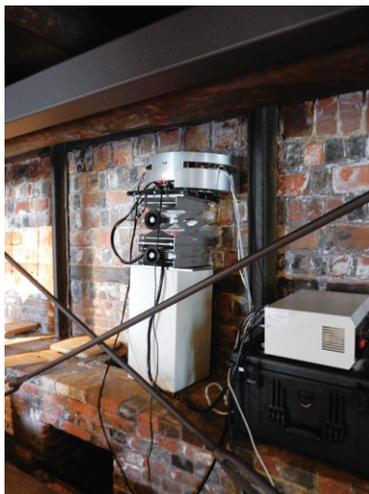
図14 可搬型X線回折分析装置を用いたオンサイト分析
