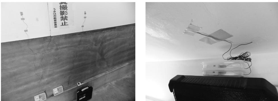
図5 表面温度測定用データロガーの設置状況
