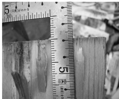
図10 塗布した部材の断面図
