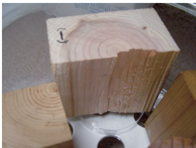
写真3 2週間後の薬剤を塗布していないスギ材 (カビが生え始めている)
