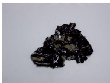
写真7-1 本試料におけるちぢみムラの状況
