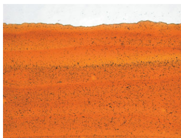
写真11 頸部付着の本試料(黒色系漆塗料)の 塗膜断面に観察される塗り重なり状態(500倍)
