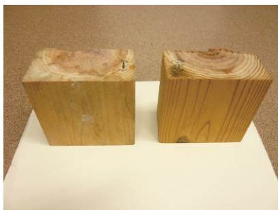
写真6 約1年2ヶ月後のスギ材 左：薬剤なし 右：DDAC塗布
