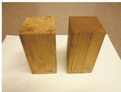
写真7 約1年2ヶ月後のヒノキ材 左：薬剤なし 右：DDAC塗布
