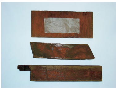
写真5 試料No.3, 9, 11の奈良時代当初材 材のベンガラ塗装の状態
