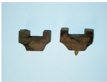
写真8 試料No.28, 29の江戸時代後補部 材である巻斗のベンガラ塗装の 状態
