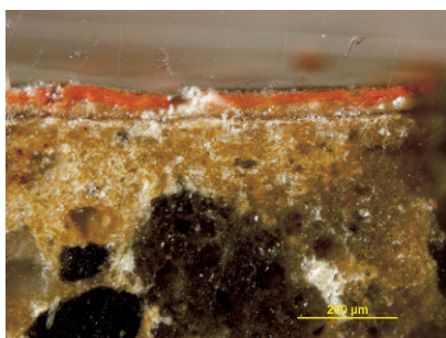
写真2 通常光源下におけるクロスセクション像
