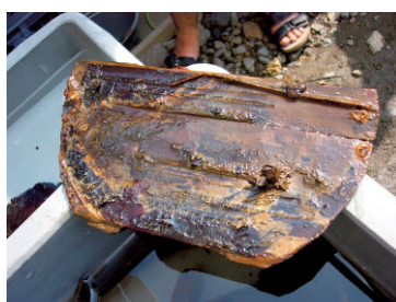
写真7-2 一般的な日本産漆のちぢみムラの状況
