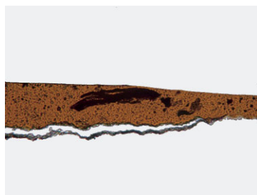
写真10 本試料(黒色系漆塗料)の塗膜断面に 観察される樹皮かす等の不純物(100倍)
