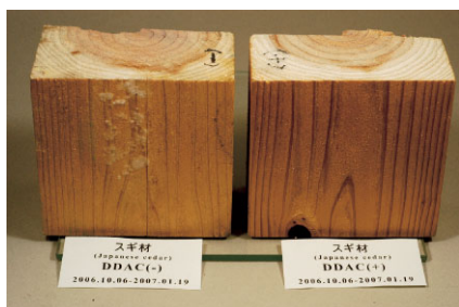
写真4 約3ヵ月後のスギ材 左：薬剤なし 右：DDAC塗布
