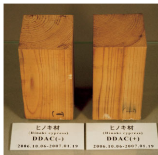
写真5 約3ヵ月後のヒノキ材 左：薬剤なし 右：DDAC塗布
