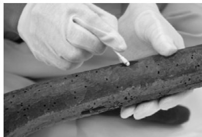
写真6 エタノール水溶液による除去
