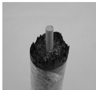
写真11 補強材と挿入状況
