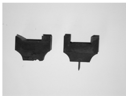
写真10 試料No.33, 34の明治以降後補部材である巻斗のベンガラ塗装の状態
