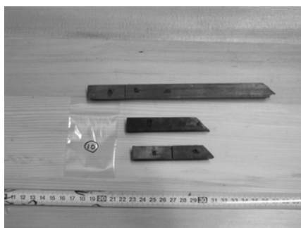
写真9 試料No.27の江戸時代後補部材である地垂の鉛丹顔料の付着状態
