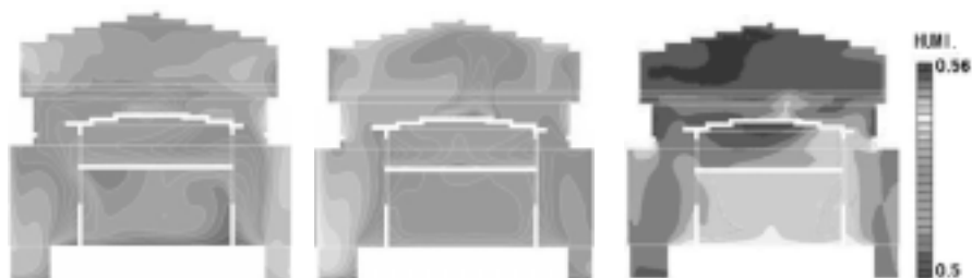
図20 梅雨時の湿度分布(左：CASE 3 中央：CASE 2 右：CASE 6 / 6月15日21時)
