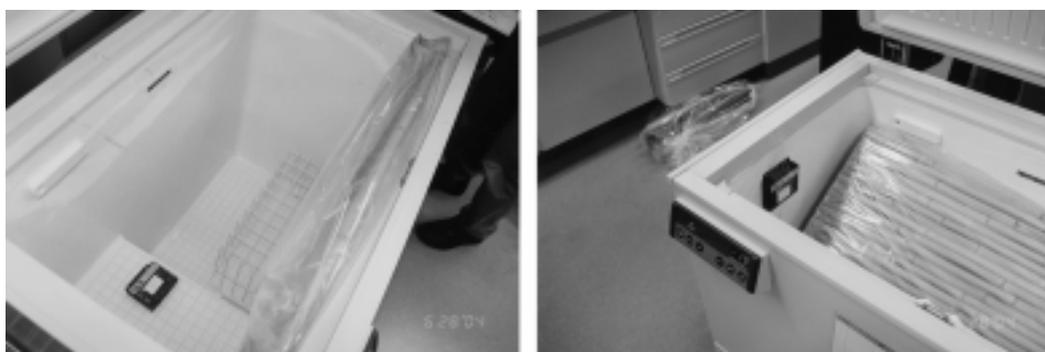
写真4 冷凍庫の資料の下部(写真左)および資料の上部(写真右)にそれぞれ設置されたデータロガー
