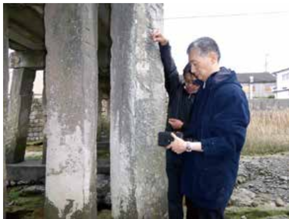
重要文化財・祇園橋における石材の水分量調査 （熊本県本渡市）
