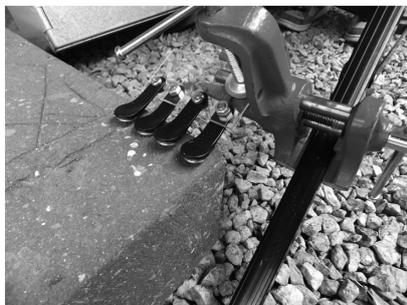
屋外に置かれた石材表面における水分蒸発量の測定
