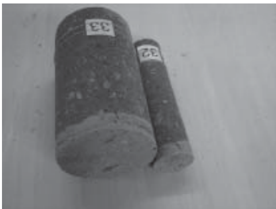
壁石のボーリングコア写真 (表面から数cm変色している、北海道開拓の村)
