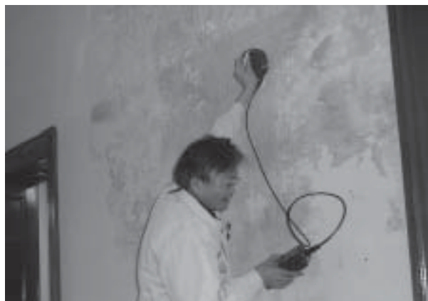
TDR水分測定装置による壁面水分分布の測定 (旧日本郵船小樽支店)
