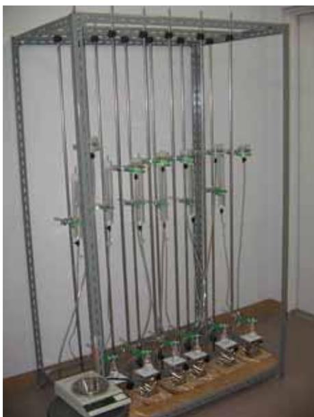
写真1：ハンギングコラム法による水分特性測定の様子
