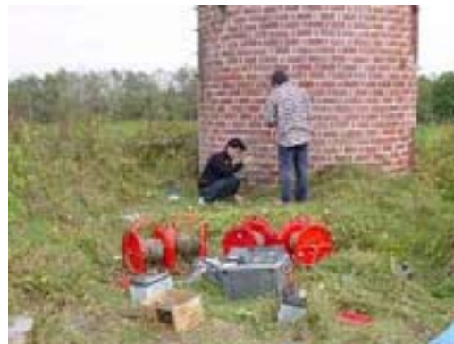
帯広市のレンガサイロ表面の含水率を電気探査で測定している様子
