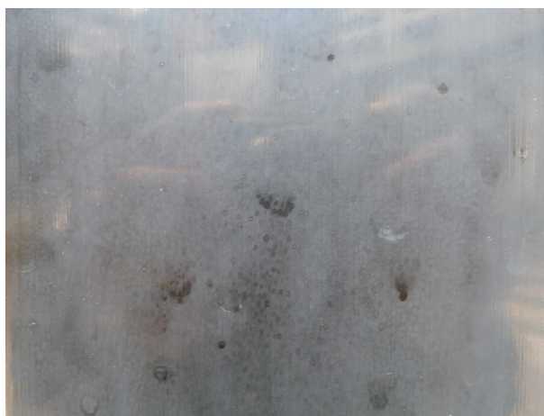
写真1 黒漆塗膜上における水滴の接触痕の例
