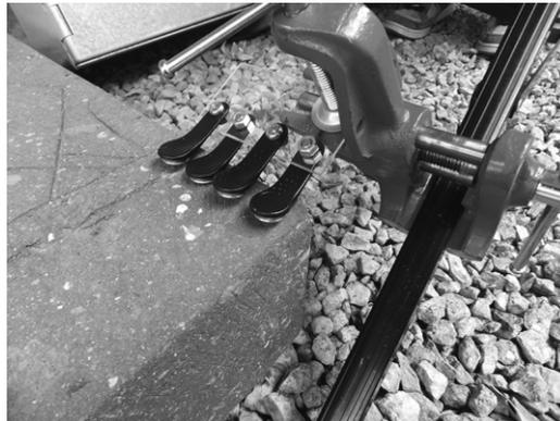
図5 レプリカ石材表面の水分蒸発量の測定
