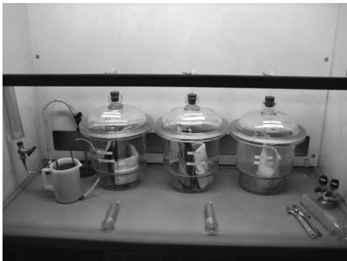
写真3 デシケーター内での殺菌燻蒸処理
