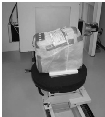
図2 CTでの被害材A測定の様子
