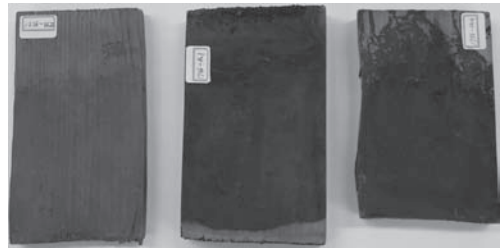
写真2 面戸板に塗装された試料1,2,3の痕跡
