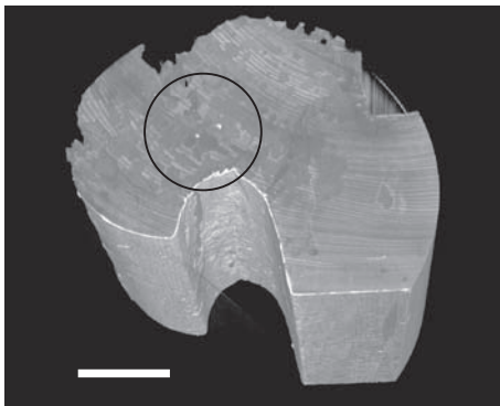
図4 被害材1をある面で切った三次元断面像の例。丸内の2箇所白い部分が虫と推定される。
