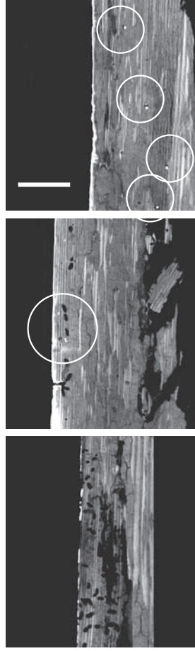
図6 被害材1の三次元画像の木目方向の断層像の例。虫の体と推定される白い像の例を丸で囲んで示した。図中のバーはおよそ50mm。
