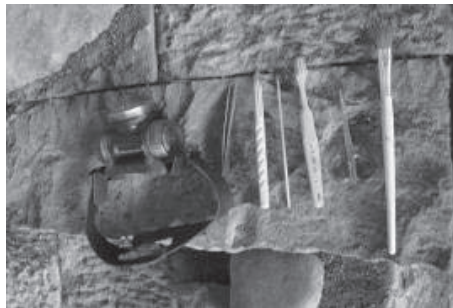
写真3 着生生物除去に用いる道具類
