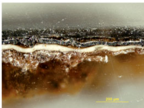
写真4 a, b 金色部分のクロスセクション。通常光源による顕微鏡写真（左），同視野の紫外線蛍光写真（右）。
