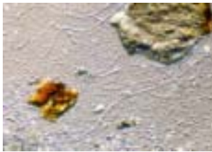
写真3. 2005年1月の石室内東壁の粘塊状物質を観察した像 (微分干渉×510) 細菌, 酵母様細胞, カビなどが混じっている様子が窺える
