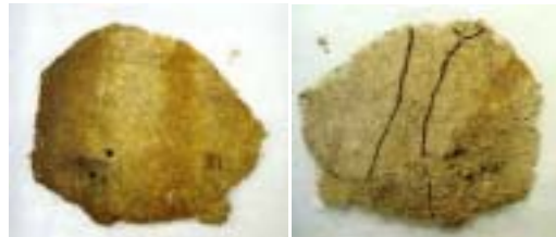
写真6. 2005年7月1日, 石室西壁からとりはずした漆喰片 (幅約12cm) に見られた穴 (写真提供: 修復技術部, 川野邊渉)
