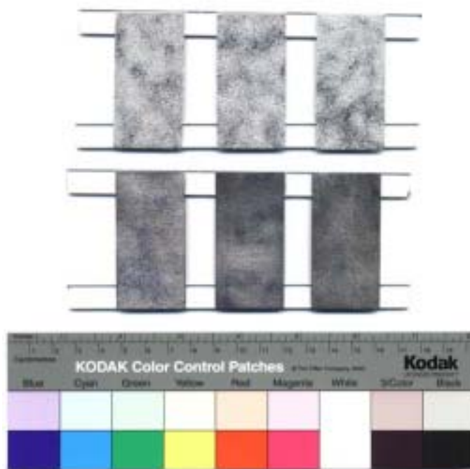
写真1. 岩石加工した錫および鉛片試料の燻蒸による変化 (左から燻蒸前、燻蒸後穴あき容器保管、燻蒸後密閉容器保管)
