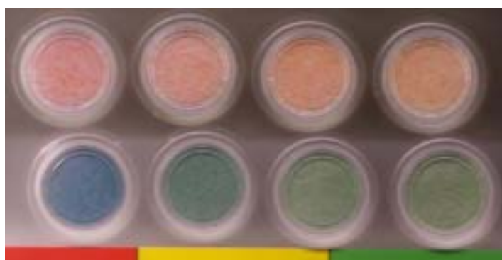
写真1 パッシブインジケータ®の色変化と評価 上段 アンモニア用インジケータ 左より -, +, ++, +++ 下段 有機酸用インジケータ 左より -, +, ++, +++
