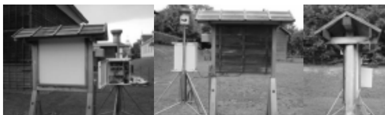
写真5 屋根を付けて屋外に再設置した試験壁と計測機器の外観
