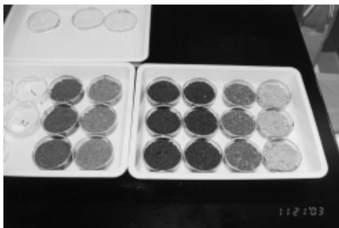
写真1 土に樹脂をかけた試料の例
