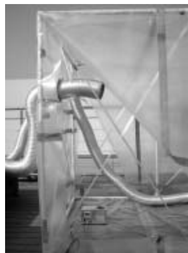
写真 2 配管およびホルムアルデヒド発生装置配置の詳細
