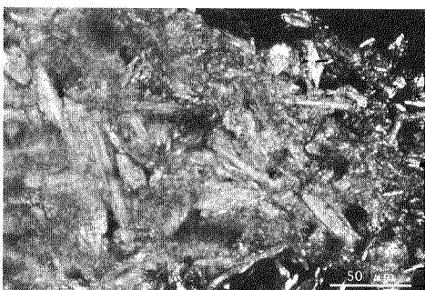
図15 貝殻胡粉の偏光顕微鏡写真 貝殻起源と見られる破片状粒子が多数認められ、漆喰の組織とは明瞭に異なる。
