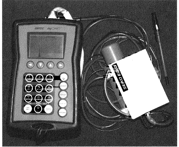
図4 本研究で開発された分析器 小型かつ軽量の装置で、すぐに構成 元素を確認できる。
