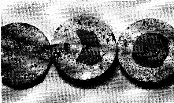
図-20 シリコン樹脂の凝灰岩への浸とう状態 Fig. 20 Absorbed silane in Tuff
