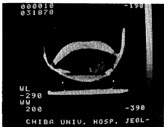
図-8 仏像の大腿部で撮ったXCT像
