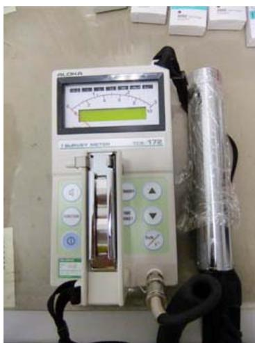
図 NaI(Tl)シンチレーション式サーベイメータ（エネルギー補償付き）
