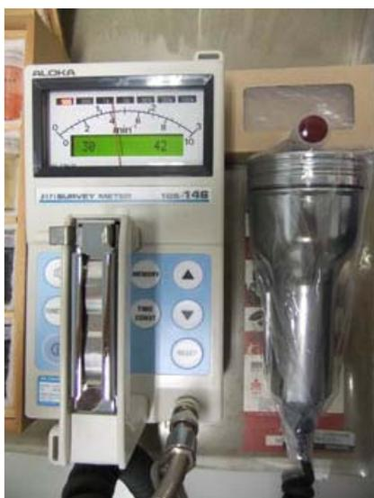
図 左：GM 管式サーベイメータ
