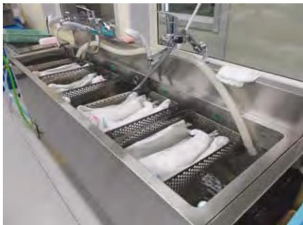
図 13 大型水槽による効率的脱塩
