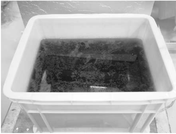
脱塩の過程で汚濁した脱塩液の表面に生じた油膜
