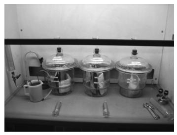
写真3 デシケータ内での殺菌燻蒸処理
