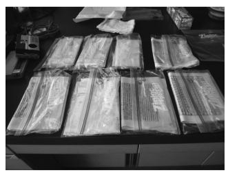
写真2 3.5%食塩水に浸した後、実験に供した冊子体の例
