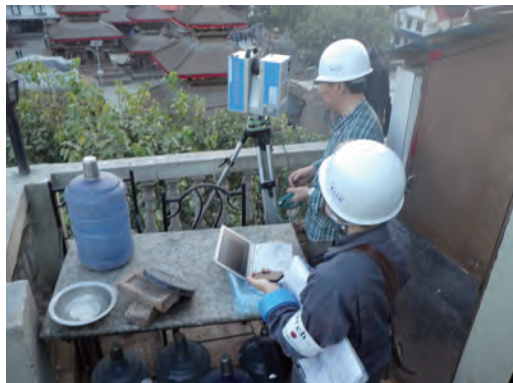
図 1-9 構造に関する調査 -2 (ハヌマンドカ王宮の3次元計測)
