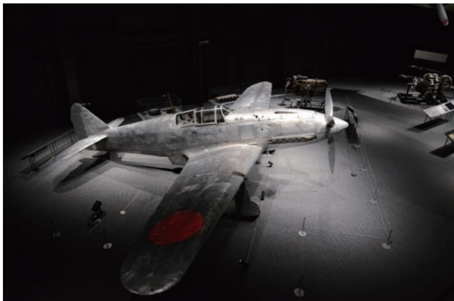
飛燕全景。右主翼上面の国籍マーク(日の丸)は投射された赤色光で再現されています。 Complete view of the Hien . The national insignia (red roundel) on the surface of the right-hand main wing is reproduced with projected red light.
