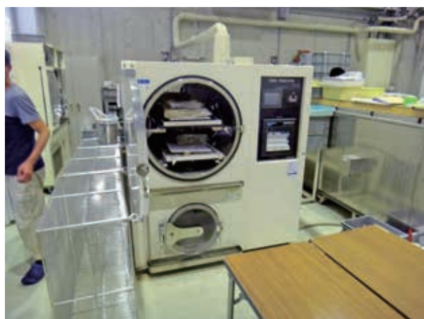
水損資料を乾燥させている真空凍結乾燥器
