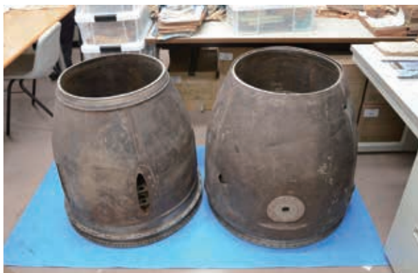
研究所に運び込まれたジェットエンジンの排気ノズル2点。右側の部品はカバー付き Two jet engine exhaust carried into the laboratory. The right part has a cover
