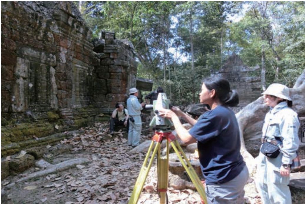
写真測量標定点の TS 計測
