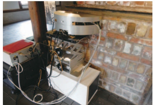
可搬型X線回折分析装置を用いた煉瓦造文化遺産の調査 Investigation of brick cultural heritage using portable X-ray diffraction analyzer
