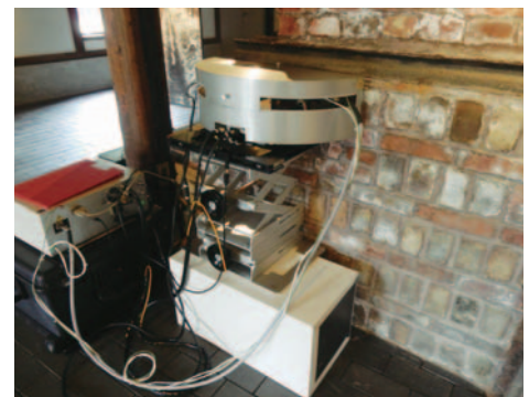
可搬型X線回折分析装置を用いた煉瓦造文化遺産の調査 Investigation of brick cultural heritage using portable X-ray diffractometer
