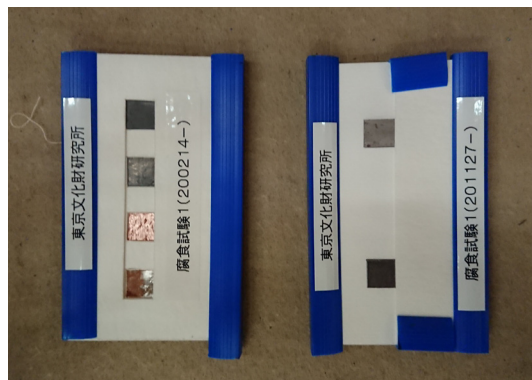
金属試料を用いた暴露試験
